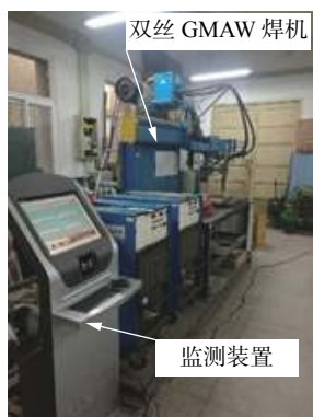
图5 双丝 GMAW 监测教学实验平台照片
