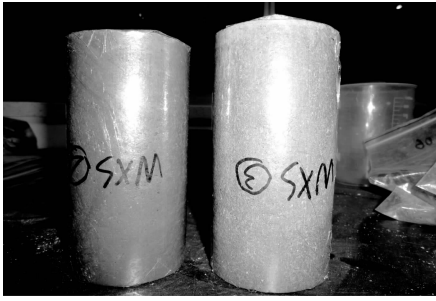
图3 硫酸钠盐渍土降温前后土样对比
