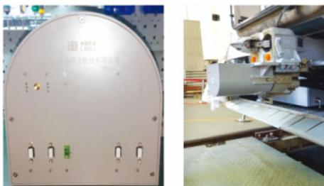
图 2 贯通指令信号采集控制器实物图
