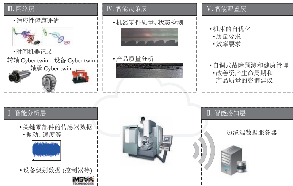
图6 工业人工智能生产线机床的5C架构体系
