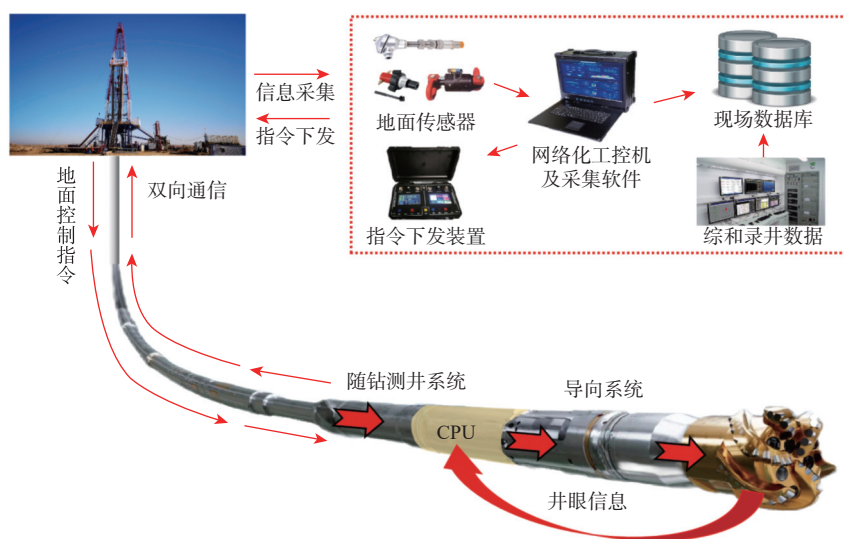
图 3 旋转导向系统的组成
