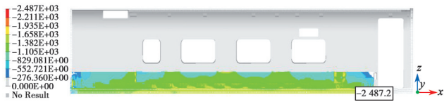
(c) 低温-40 °C下压缩应变云图
