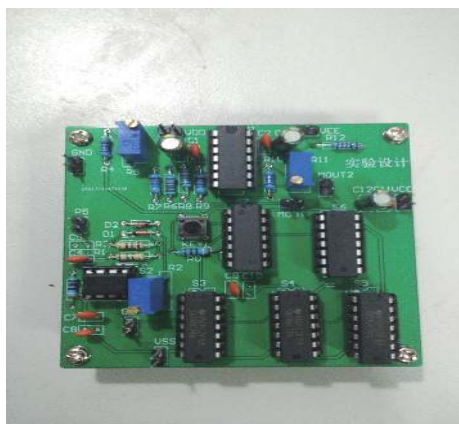
图 16 实验焊接的电路板
