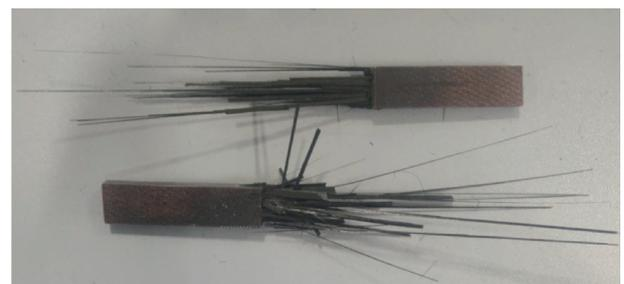
图 2 0° 拉伸试样的散丝状断口
