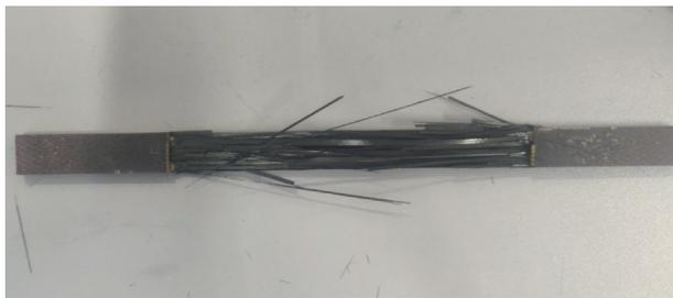
图3 0°拉伸试样的未断裂破坏形式
