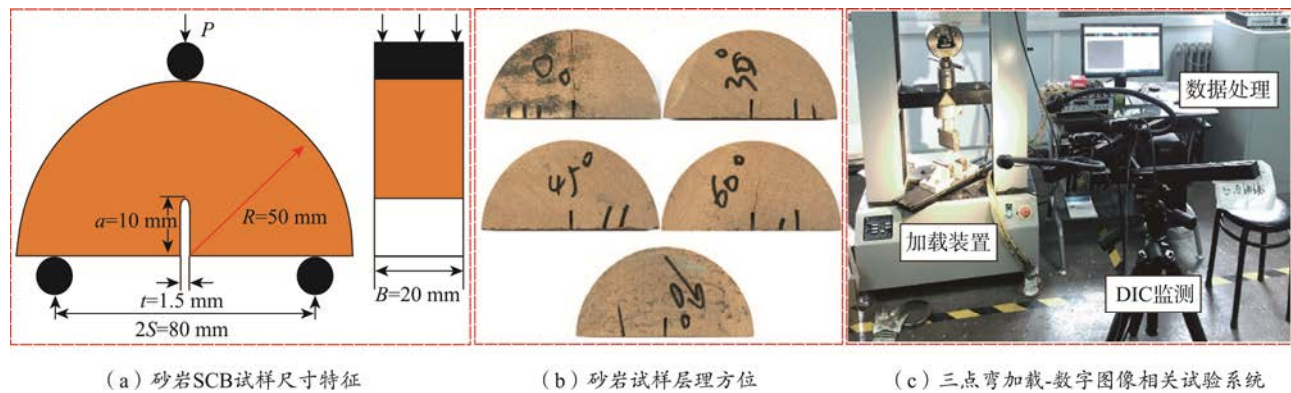
图1 致密砂岩SCB试样三点弯加载及数字散斑监测实验系统
