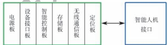
图2 车载智能数据装置构成
