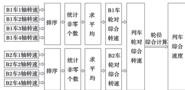
图 8 国产牵引车速度获取逻辑图
