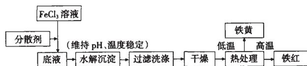
图 1 加碱中和法制备纳米氧化铁粉体工艺流程图
