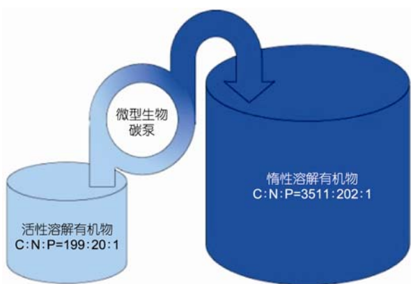
图 6 “海洋微型生物碳泵”储碳效应示意图——微型生物生态过程储存碳、释放氮磷 [54]
