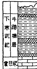
圖4c.黔北某地磷礦柱狀圖 1,2,3—礦層
