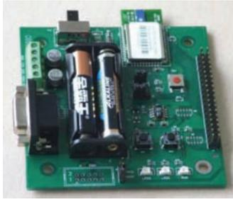
图2 通信节点转接扩展板实物
