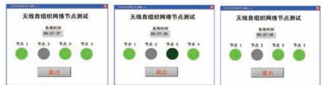
(a) 正常情况 (b) 节点 3 电源关闭 (c) 节点 3 电源重启
