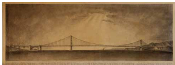
图3 莫伊塞弗和埃利斯共同设计的纯悬索桥梁 图片来源:文献[6]。
