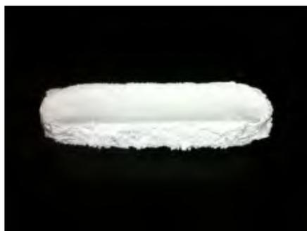
图 29 氧化铝/氧化锆混合粉 SLM 打印成型效果<sup>[33]</sup>
