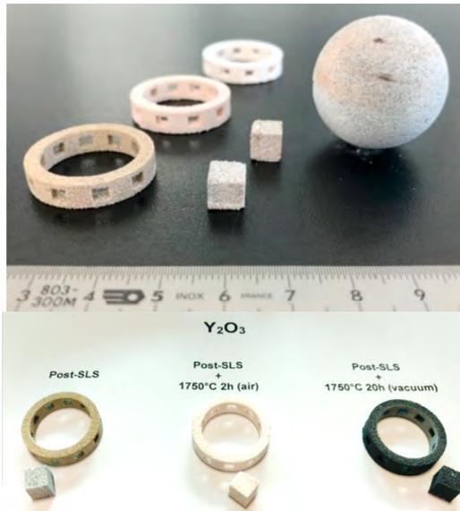
图 32 氧化钇粉体在不同处理条件下的打印效果<sup>[35]</sup>
