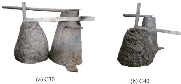
图3 机制砂混凝土 C 坍落度
