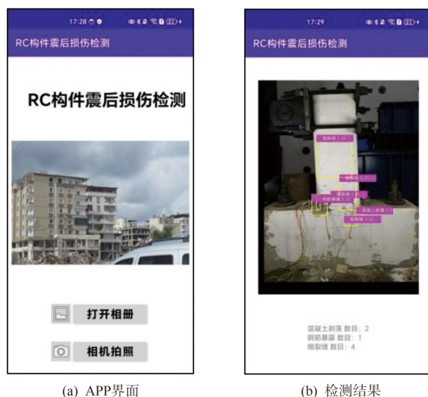
图14 RC构件震后损伤检测APP
