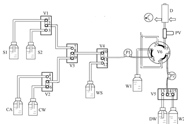
图 1 在线测定亚硝酸盐的 SIA 的流路图
