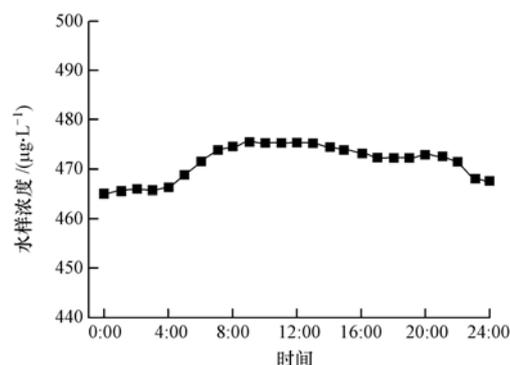
图6 实际水样的在线实时检测
