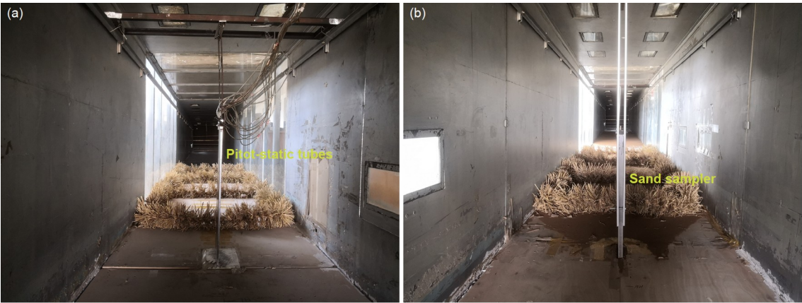
图 3 (网络版彩图) (a) 不同位置风速测量; (b) 输沙量测量
