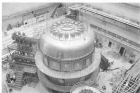
EAST 非圆截面全超导托卡马克核聚变实验装置
