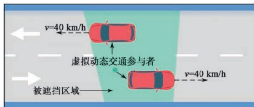
图4 基于虚构动态交通参与者的盲区物体推测方法
