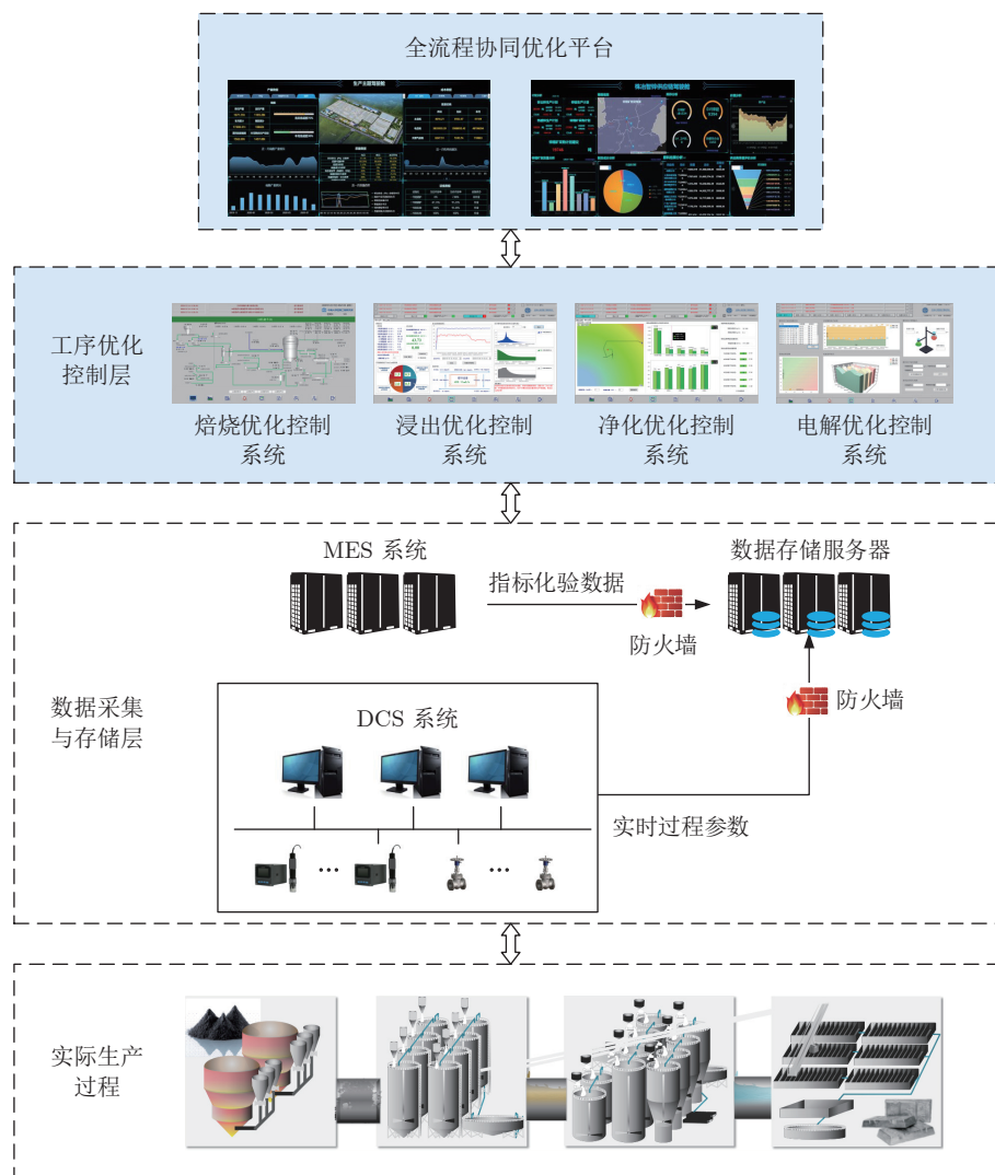
图 7 锌冶炼过程协同优化与智能控制系统架构
