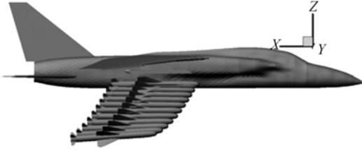
图 30 导弹发射过程中位置随时间的变化过程
