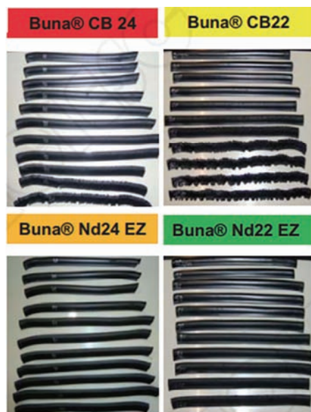
图2 CB和EZ系列稀土顺丁橡胶挤出物表面对比 [46] 。从上至下挤出速率从20 r/min增加到120 r/min
