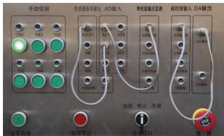
图4 传感器信号与采集板卡的连接
