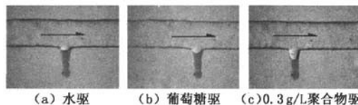
图4 不同驱替液连续驱替“油湿”盲端类残余油的效果
