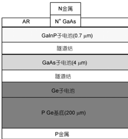
图 1 GaInP/GaAs/Ge 三结叠层电池的结构示意图
