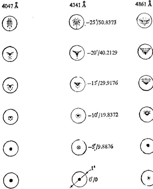
图 4 2.16m 望远镜主焦点改正器的点图
