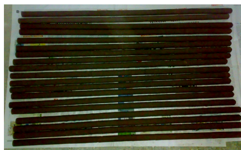
图 1 中国矿业大学(北京)研发的 SOFC 阴极支撑管
