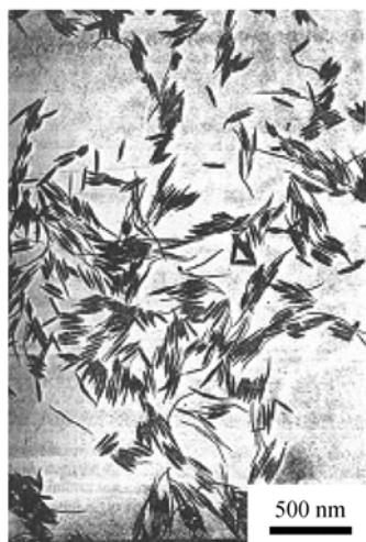
图2 针状 Te 纳米晶的 TEM 图像 [32]
