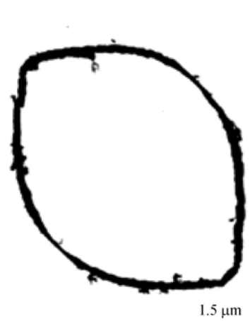
图 8 椭圆形 PbS 闭合纳米线的 TEM 图像 [58]
