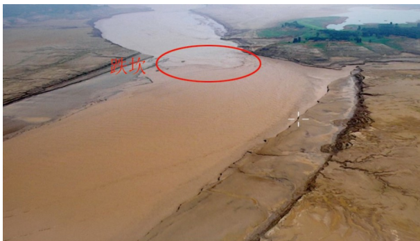
图4 (网络版彩图) 2020年7月28日小浪底水库跌坎上溯至HH11断面处
