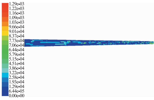
图 6 二氧化硅粉尘颗粒在管壁上的沉积云图
