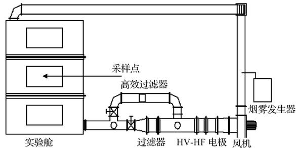
图2 电凝并式空气净化实验系统示意图
