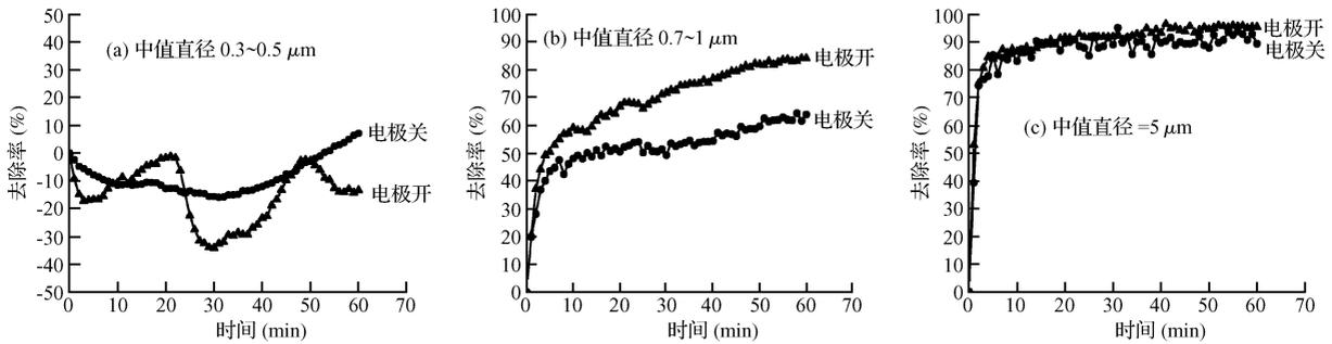
图 5 各粒径颗粒物净化效果比较图
