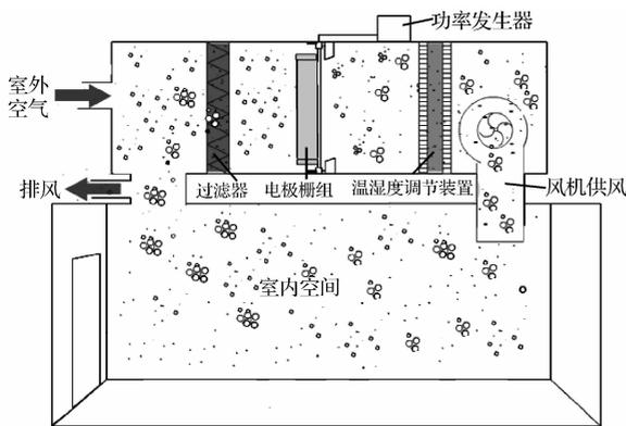
图1 电凝并空气净化系统示意图
