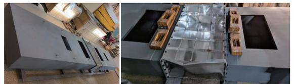
(a) 拼接后的试验模型 (b) 压载崩溃后的试验模型
