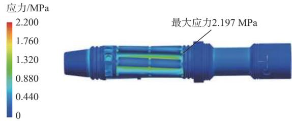
图 9 测量短节扭转应力图
