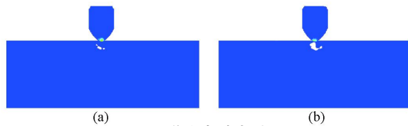
图 4 弹头齿破岩过程图
