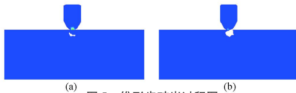
图 5 锥形齿破岩过程图
