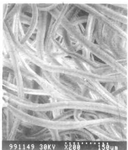
图 2 2h后对照滤嘴于清水中放大 200倍照片
