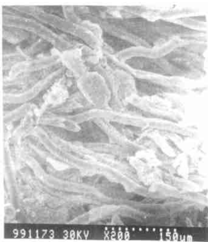
图 3 10d天后样品于污泥中放大 200倍照片
