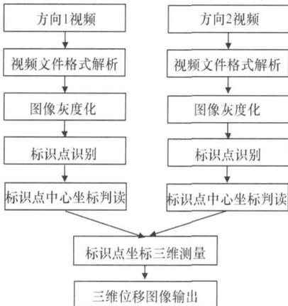
图 7 三维测量实现过程
