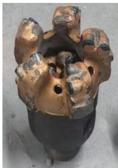
图9 室内试验专用诱导卸荷与磨料射流联合作用钻头
