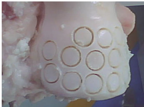
Fig. 3 Schematic illustration of cartilage sample 图 3 软骨销试样图
