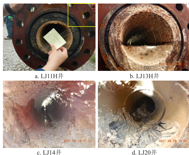
图 3 罗家寨气田集输系统试验管段元素硫沉积状态对比图
