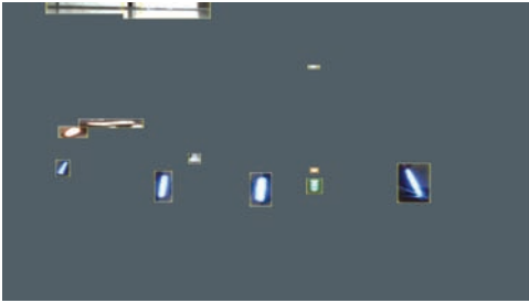
图 6 矩形拟合所得伪 ROI 图像 Fig. 6 Pseudo ROI image after rectangle fitting
