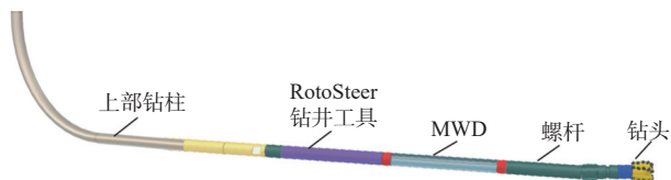
图2 RotoSteer 钻具组合示意
