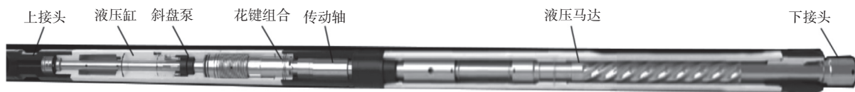
图1 RotoSteer 钻井工具结构示意图
