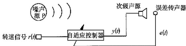
图2 车内噪声主动控制系统基本模型
