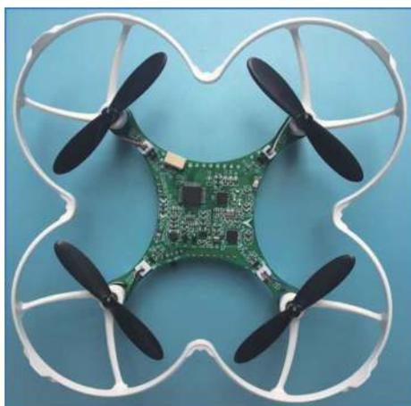
图 2 四旋翼无人机实践教学平台硬件实物图
