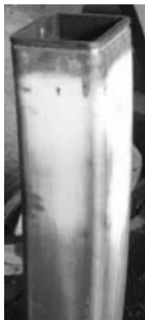
图3 结晶器铜管结垢
