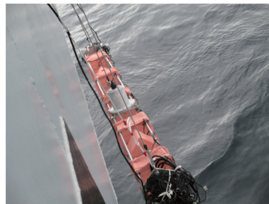
图9 矢量水听器吊放现场
