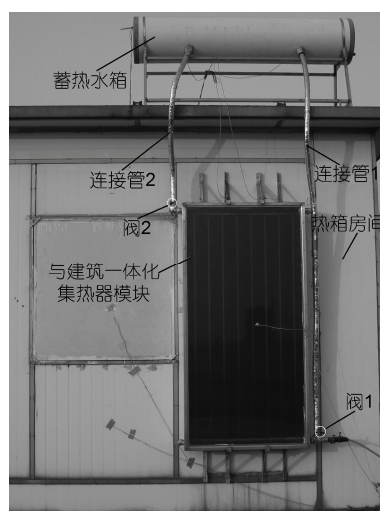
图1 与建筑一体化太阳能双效集热器系统实验平台
